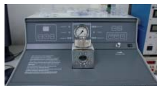
Unidad de desecación para muestras biológicas Bal-tec CPD 030
