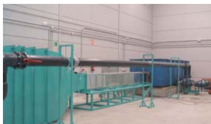
Túnel hidráulico / Canal de arrastre
