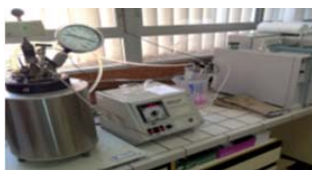
Reactor para reacciones a presión acoplado con CG
