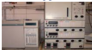
Reactor Actividad Catalítica acoplado con CG
