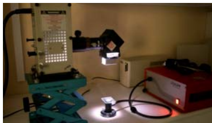
Validación y control de calidad espectral e intensidad de lámparas UV y sistemas de simulación solar
