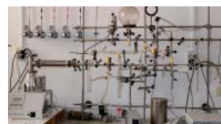
Líneas de vacío
