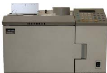
Cromatógrafo de gases Perkin Emler GC-Autosystem con detectores (FID, NPD, ECD y TCD)
