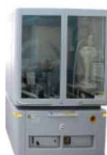
EMPYREAN de PANalytical (Cu reflexión-transmisión, detector 2D)
